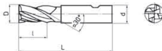
120517 - Dodáváme s AlTiN povlakem, 120518 i v povlakovém provedení (TiN, TiCN, TiAlN).
