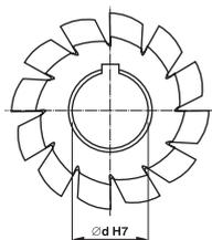
**Použití:** Frézy se používají k frézování ozubení u řetězových kol, pro hnací válečkové a pouzdrové řetězy ČSN 014811, DIN 8196.
